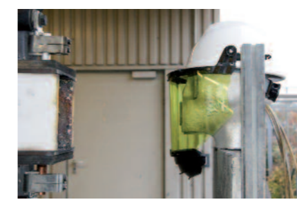
MSA vlamboogset vóór box-beproeving 7 kA
